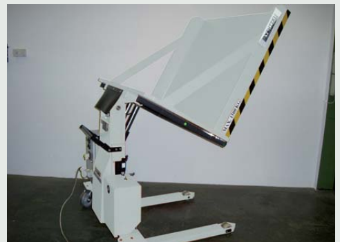
NHE 305-S in geneigter und angehobener Position
