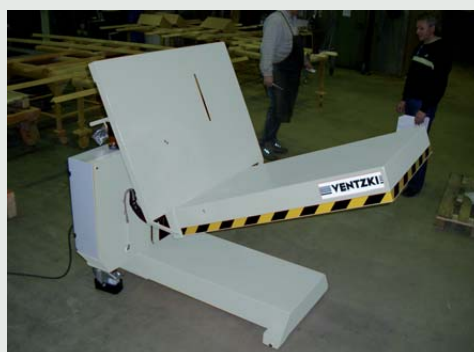
NHE 305-S mit Fahrtrieb und Ladehöhenkontrolle durch Lichttaster
