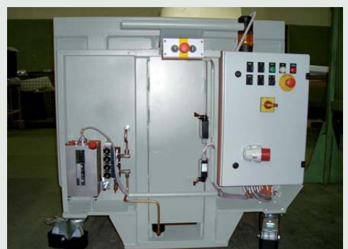
NHE 305-S mit Fahrtrieb und Ladehöhenkontrolle durch Lichttaster
